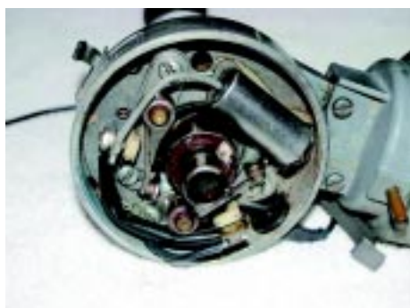
foto 8 Een Boss 429 verdeler met een dubbele set contactpuntjes.
