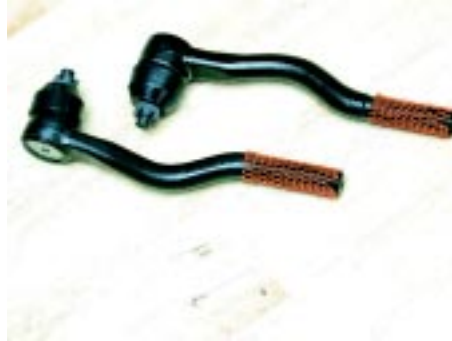
Binnenste spoorstangen voor een '65-'66 voor een Mustang zonder stuurbekrachtiging.
