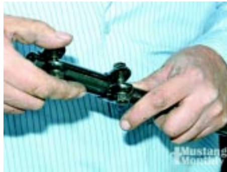
Gebruik een dun laagje vet om de lange stelmoeren en het schroefdraad van de spoorstangen te smeren. Dit maakt het stellen in de toekomst gemakkelijker. Let ook op de positie van de bouten aan de stelmoeren.
