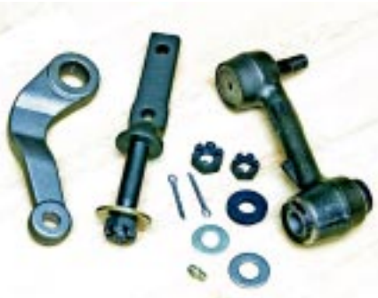
Idler arm (rechts) en Pitman arm (links). Dit is een Pitman arm voor stuurbekrachtiging, zonder de kogel die bij een niet stuurbekrachtiging gebruikelijk is.
