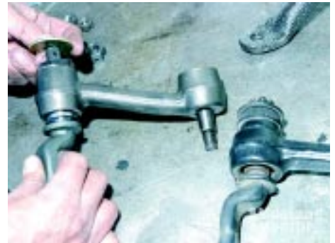
Monteer de idler arm en de ophanging aan elkaar met de kroonmoer en nieuwe splitpen. En maak die vervolgens aan de centerlink vast met een kroonmoer en nieuwe splitpen.
