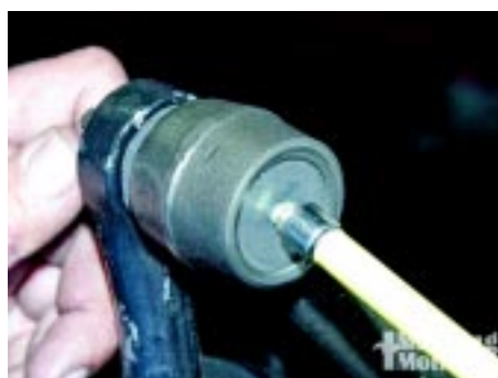
Je hebt de keuze om zgn. zerk vetnippels te monteren. Rijdt je veel dan zijn vetnippels gemakkelijk, omdat je dan regelmatig vet kunt inspuiten. En anders verwijder je de nippels en monteer je voor een kapje voor origineel uiterlijk.
