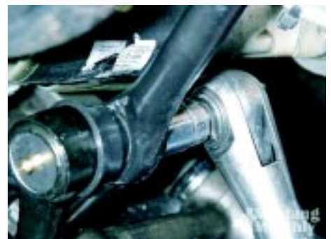
De binnenste en buitenste spoorstangen kunnen nu vastgemaakt worden.
