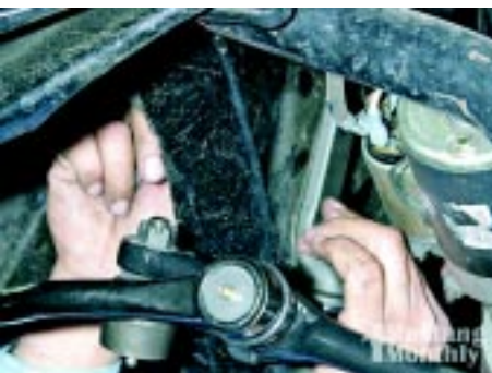
Monteer de ophanging van de idler arm aan de carrosserie met de nieuw meegeleverde bouten.
