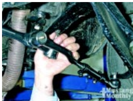
De Pitman arm wordt aan het stuurhuis gemonteerd en vervolgens kan de centerlink aan de Pitman arm worden vastgemaakt.
