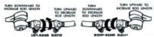
Zo stel je de toespoor af. Het spreekt voor zich dat je dat, om de juiste fabrieksafstelling te krijgen, op een uitlijnbank moet doen.
