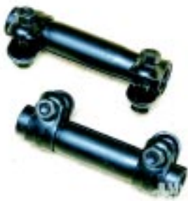
De lange stelmoeren die de spoorstangen met elkaar verbinden.
