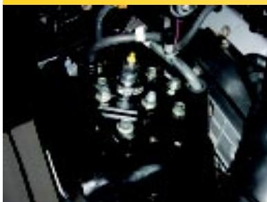
onder en twee boven de plaat en geen problemen met de motorkap. Plaats een spacer op de stang van de nieuwe schokbreker en monteren de schokbreker door het gat van de caster/camber plate, doe de twee resterende spacers er bovenop en monteren de moer van de schokbreker. Maak nu alle moeren vast. Nu moet je van onderen af de MM bumpstop en de stofhoes goed aan-
