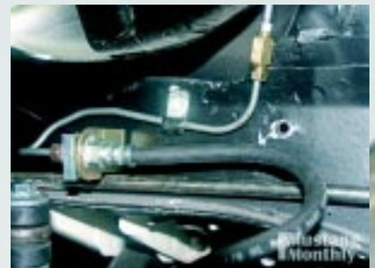
De remslang moet nu worden aangesloten op de originele remleiding. De remslang moet op een nieuwe positie worden gemonteerd op het frame, waarvoor je een gat moet boren. Vervolgens moet een nieuwe remleiding worden gemaakt om aan te sluiten op de originele remleiding. Hier zie je hoe die ongeveer gebogen moet worden.
