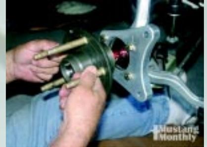
Monteer de naaf op de houders en borg deze met de kroonmoer en splitpen. Vervolgens schuif je de spacer, nadat je de binnenkant hebt ingevet, over de naaf.
