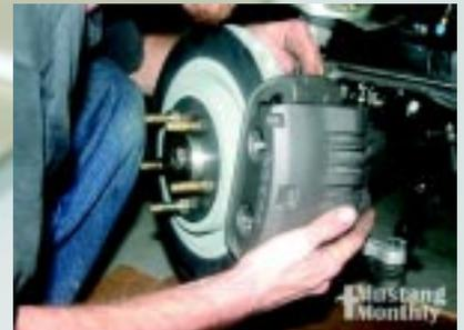
Monteer de remschijf met de wielmoeren omgedraaid, zodat die met de platte kant tegen de remschijf aan zitten en draai ze vast om alles tegen elkaar te drukken. De remzadels zitten met twee bouten vast. Gebruik een momentsleutel om die volgens specificaties aan te draaien. Plaats de remblokken in de remklauwen en monteer de remklauwen in de remzadels. Plaats de borgpen met de c-clip. Verwijder de wielmoeren weer.
