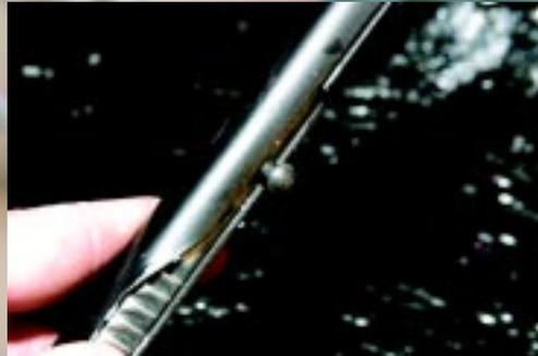
De geleidingspin is hier teruggeplaatst. Het verwijderen van die pin vergt nogal wat geduld. Het installeren kan met een hamer.
