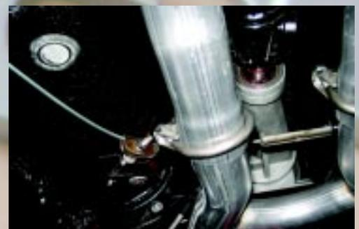
Op 67-68 Mustangs werden twee kabels gebruikt vanaf de splitter. Afstellen van de kabel is eenvoudig met een stelmoer op een draadeind.
