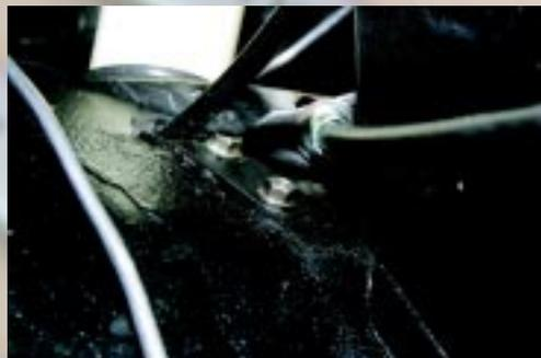
Hier gaat de handremkabel door de vloer in 65-66 Mustangs. Twee schroeven houden de kabel op zijn plaats. Let ook op de snelheidsmeterkabel links.
