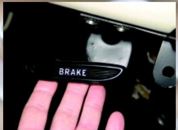
De handrem in 65-66 Mustangs bedien je door aan de hendel onder het dashboard te trekken. Alhoewel Ford ontwerpers hebben gedacht dat dit handig was, is dit niet zo. Er is namelijk geen hefboomwerking zoals bij de latere voetpedalen en centraal geplaatste handrem. Je trekt dus direct aan de kabel en daardoor kan je niet genoeg kracht leveren.
