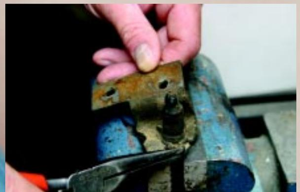
Het verwijderen van de clip die de kabel vasthoudt aan het bracket.
