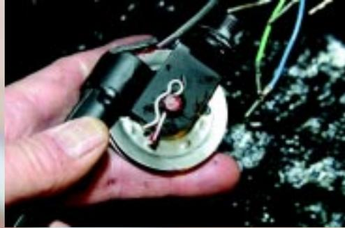
Hier zie je de handrempulley geïnstalleerd. Zorg ervoor dat de boel goed is ingevet.
