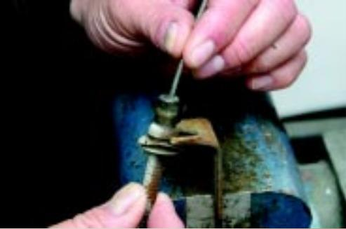
Zo zit de kabel op het bracket. Wij verwijderen de oude kabel. De nieuwe wordt geleverd met golvend ringetje voor extra stabiliteit van de kabel.
