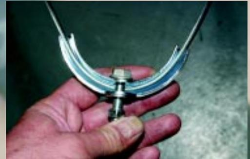
Hier zie je de verdeler waardoorheen de kabel van de beide achterremmen loopt. Zodra je aan de hendel onder het dashboard trekt wordt de hevel aangetrokken, waar deze verdeler aan vastzit. Hierdoor wordt de kabel van de beide achterremmen op zijn beurt weer aangetrokken.
