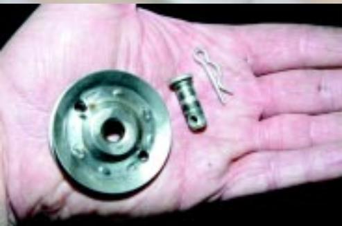
Dit is de handrempulley. Die is niet onderhevig aan roest, maar bekijk de kabelgroef goed en vervang hem als het nodig is. Gebruik ook hier weer vet voor de geleiding.
