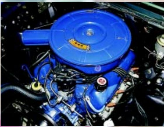
nieuwe 390ci High Performance big-block uit de FE-serie. Ford Corporate Blue was opnieuw de kleur voor alle motoren. De basis 200ci zescilinder, de 289-2V V8, de 289-4V V8 met een nieuwe carburateur, de Autolite 4300, en de 289 High Performance waren er nog steeds in 1967. Het grootste nieuws was dus de 325 pk sterke 390 met chromen klepdeksels en een chroom luchtfilterdeksel. Alle motoren dus Ford Corporate Blue.
